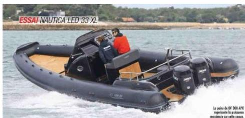
jour. Il mesure 10,60 mètres et reçoit une paire de Suzuki DF 300 APX, ce dernier appartenant à la génération précédente par rapport au V6 « Geki » qui se distingue par sa double hélice et son bloc de 4,4 litres. Cet ensemble athlétique flirte avec les 50 nœuds et déjauge en un peu moins de 4 secondes. On est en présence d'un semi-rigide nerveux, doté de sa puissance maximale et bénéficiant d'une plage de vitesse de croisière élevée, entre 27 et 30 nœuds.
