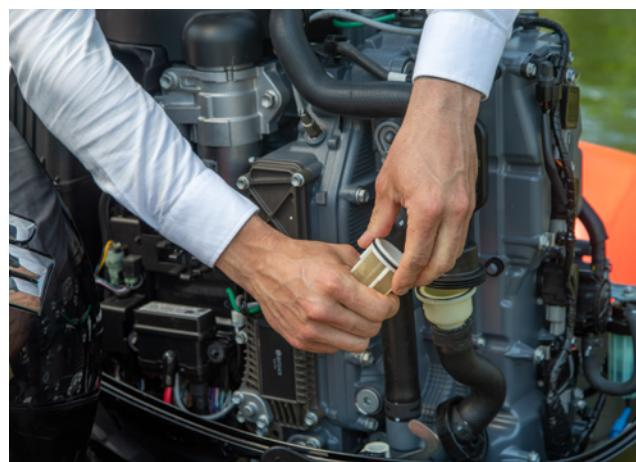
Le dispositif peut être facilement installé sur la tuyauterie de «retour», sans pour autant nuire aux performances du moteur dans la mesure où il n'utilise que l'eau de rejet ayant déjà servi à refroidir le moteur.
