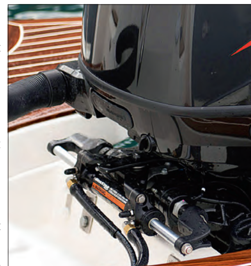
Les moteurs de plus de 115 chevaux sont la plupart du temps équipés d'une direction hydraulique.
