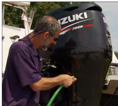
Rincer à chaud, moteur droit et éteint, permet déjà d'éliminer une bonne partie du sel.
